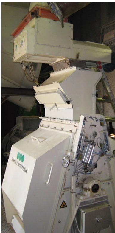
Det nyudviklede fødeapparat på slaglemøllen. Det nye fødeapparat har samme højde som det traditionelle fødeapparat for at muliggøre udskiftning.
