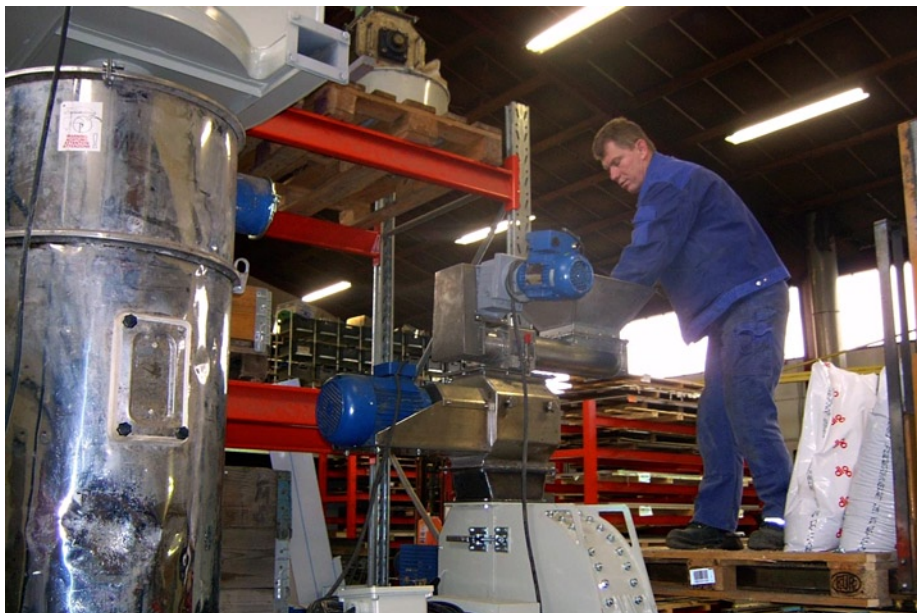
Forsøgsopstilling hos EUROMilling med formølle til grovformaling af kornet inden den endelige formaling på slaglemøllen.
