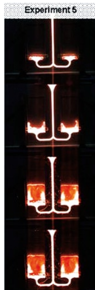
Billedserie, der viser hvordan støbejern strømmer under fyldning. Fra eksperimenter i laboratoriet på DTU.
