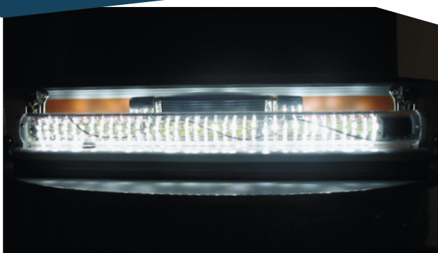
Den færdige hvide prototype inde i plexiglasrøret, monteret i et armatur, klar til tests.
