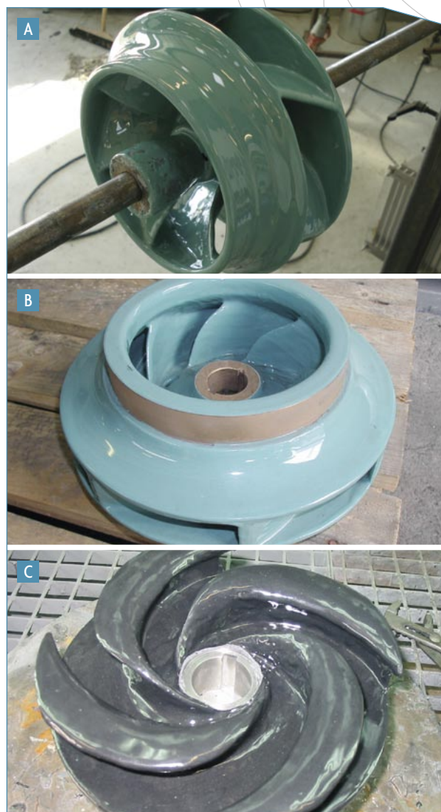
Eksempler på coatede pumphjul til forskellige pumpeopgaver: A og B: Løbehjul fra pumper placeret i en svømmehal coatet med Chesterton ARC 2. C: Løbehjul fra en spildevandspumpe coatet med Chesterton ARC 855.
