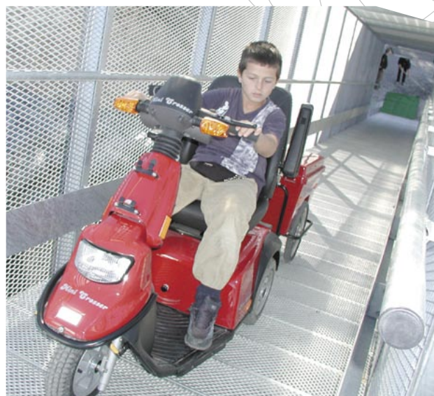
"Mini Crossover": Handicap køretøj med H 2 metalhydrid brændselscelle system.
