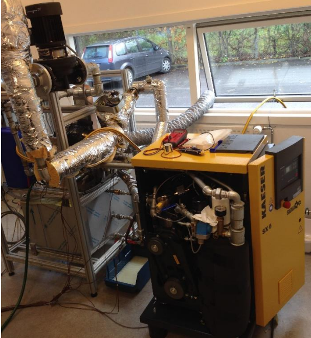
Figur 5.1 a) Billede af Kaeser kompressoraggregatet samt varmeafgiver- og olieseperationssystem. b) Billede der viser sammenkoblingen af varmeafgiveren og dampkredsen i affugteren.
