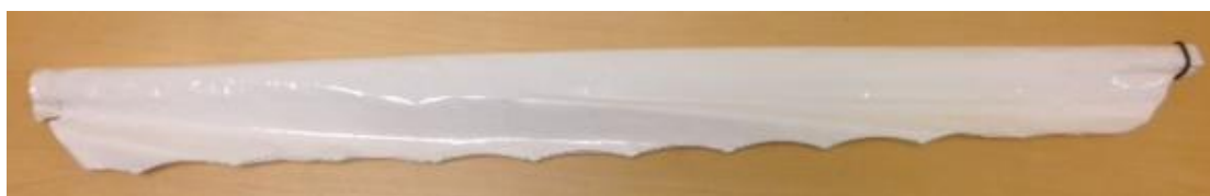
Figur 38 Stratifier 2 - PEX rør, udsparet med polymerfilm
