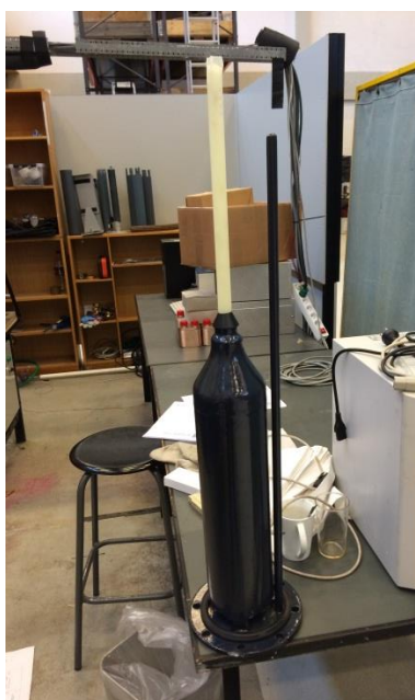
Figur 58 Principskitse af varmtvandsbeholder samt billede af stålkappen med pexrør (midt) og varmtvandsbeholder (til højre).
