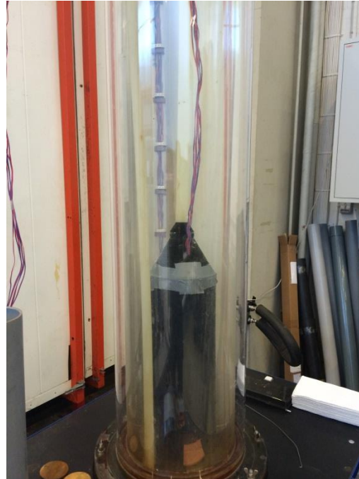
Figur 32 Billede af 110 mm stålrør med konisk plasttop mod pexrør.
