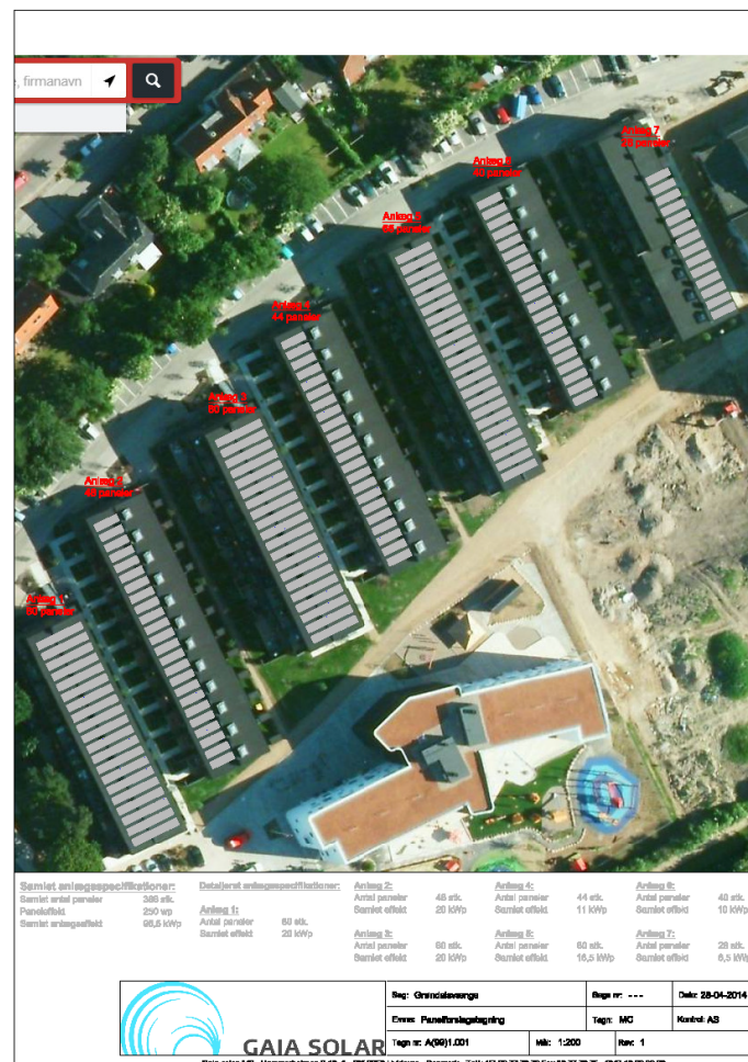
Figur 4-2 Gaia Solars forslag til placering af solcellemoduler i Grøndalsvænge. Anlægget ville have fået en installeret effekt på ca. 100 kWp med en årlig simuleret elproduktion på ca. 88.000 kWh og en anlægspris på ca. 1,65 mio. kr., inkl. moms.
