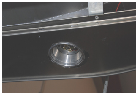
Figur 19 Ny LED lyskilde udviklet til brug i emhætter. Her monteret i demonstrationsemhætten uden diffuser installeret.
