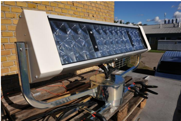
Figur 10 Opsætning af SP3 system med optisk probe monteret på undersiden af systemet til måling af spektral irradians indfaldende på systemet
