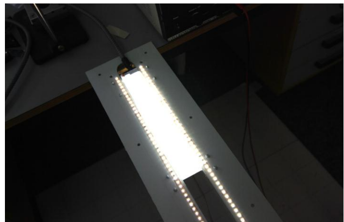
Figur 27 Foto af fiberlys koblet ud af lysblandingsklodsen, hvor de hvide LEDer i hybridarmaturet er tændt.
