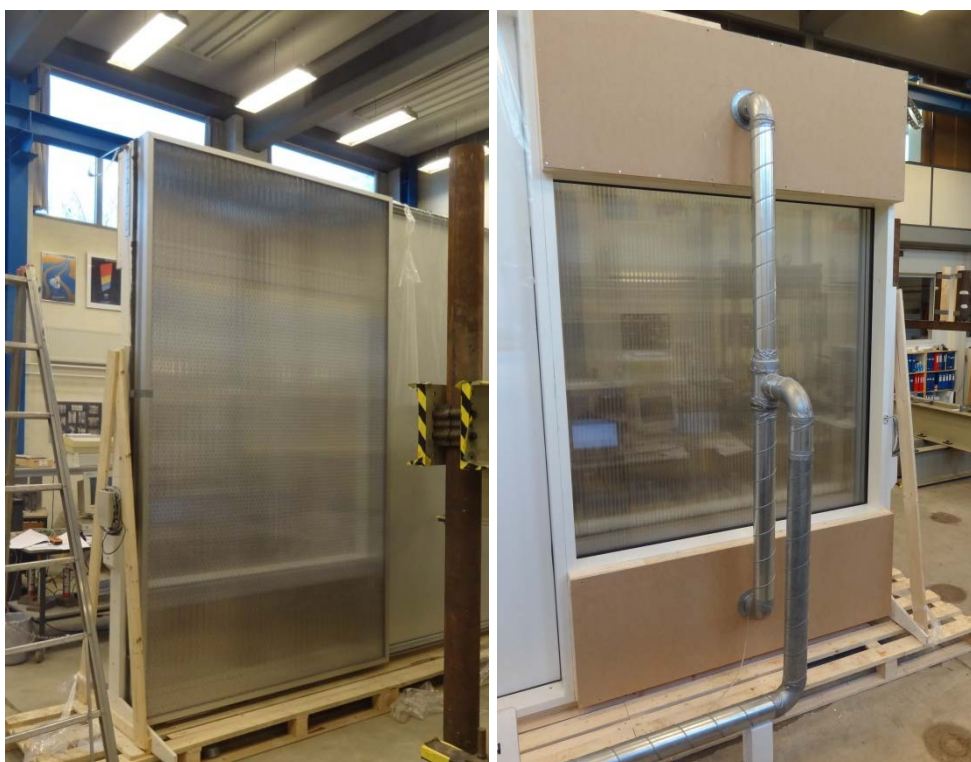
Figur 26. Fotos af opstillingen til undersøgelse af isoleringselementets tæthed i lukket tilstand.
