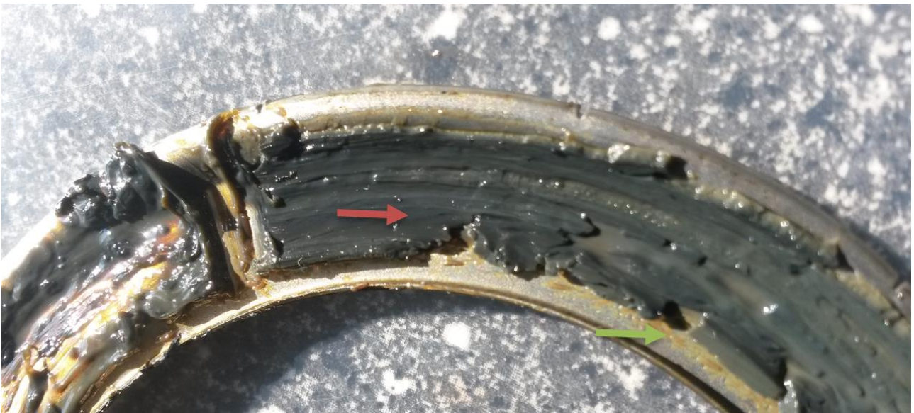
Figur 9-9 Fedt på indersiden af tætningen på NSK 6309 lejet fra gammel motor. Den grønne pil angiver område med fedt der minder om original fedtet, den røde viser den tilstand det meste fedt er i.
