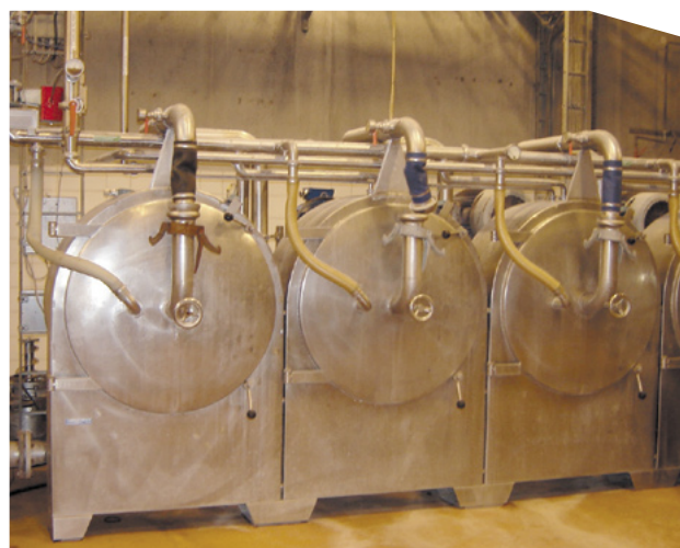
Brug af hydrocyklon i denne ekstraktionslinie på AKV Langholt skønnes at kunne spare mere end halvdelen af elforbruget. En af de tre andre danske kartoffelmelsfabrikker har efter afslutning på forprojektet besluttet at investere i et hydrocyklonanlæg. Foto taget af AKV Langholt.
