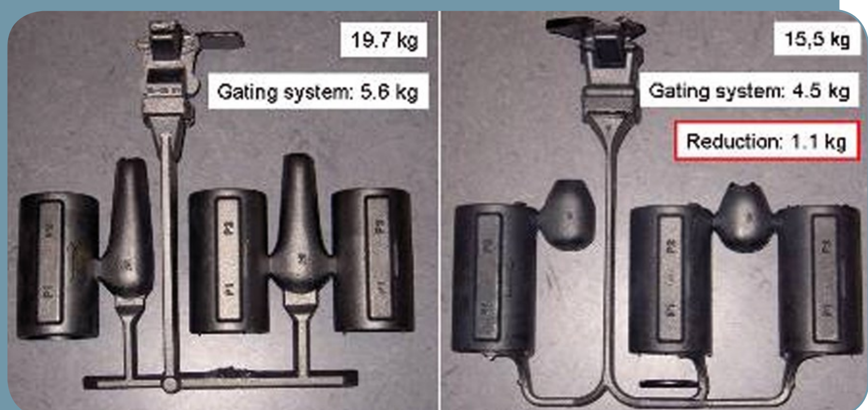
Her ses i praksis, hvad man kan opnå ved at optimere indløbssystemet både mht. design og vægtbesparelse.
