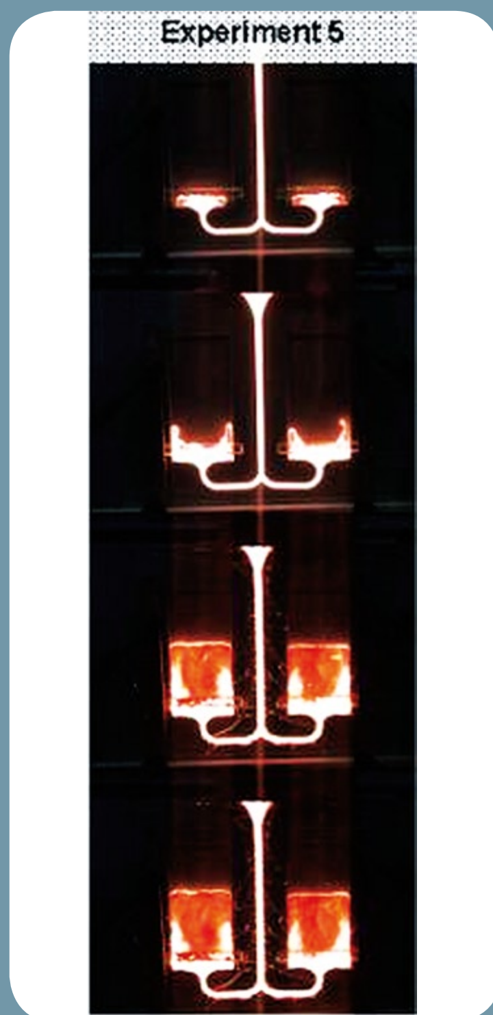
Billedserie, der viser hvordan støbejern strømmer under fyldning. Fra eksperimenter i laboratoriet på DTU.
