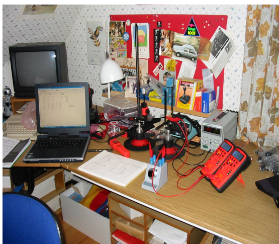
Figur 4-2: Forsøgsopstillingen. Fra venstre til højre ses PC til notering af måleresultater i et regneark. Stativ til LED og Luxmeter. Strømforsyning med potentiometer. Amperemeter og voltmeter.
