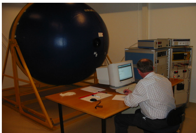
Figur 6-2: Det samlede udstyr til måling af lysstrøm. Til venstre ses den lukkede fotometerkugle, til højre ses måleinstrumenter og strømforsyning.
