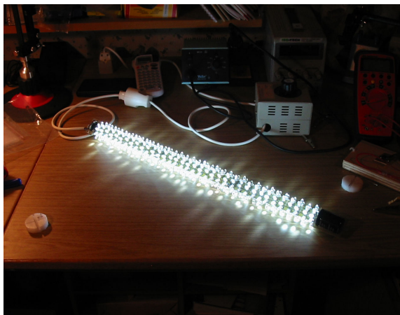
Figur 5-9: Prototypen uden plexiglasrøret. Forsynet direkte med 230 VAC.
