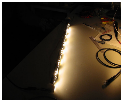
Figur 5-32: Udstålingen fra den varme hvide prototype er tilnærmelsesvis kontinuert, ligesom et lysstofrør.
