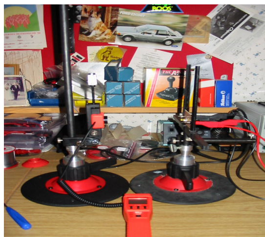
Figur 4-3: Til venstre stativet til luxmetret. Til højre stativet til lysdioden som skal testes. Stativerne er placeret 12 cm fra hinanden, således at dioden lyser direkte ind i luxmeteret. Under forsøgene er stativerne overdækket af mørklægningsstof.
