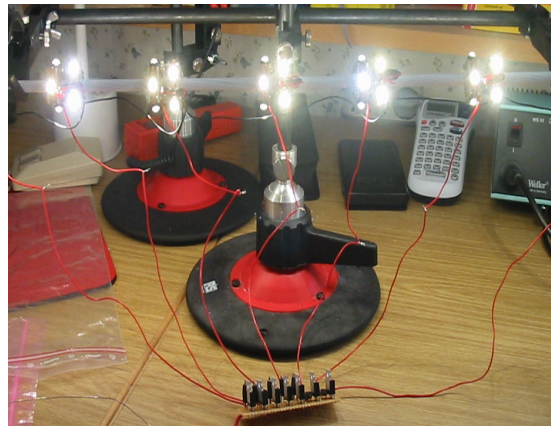
Figur 5-16: 1. Prototype med lysende lysdioder. I forgrunden ses de syv strømbegrænsere monteret på Veroboard.
