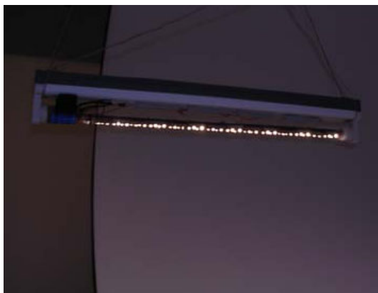
Figur 6-7: Den varm hvide prototype monteret til test i fotometerkuglen.
