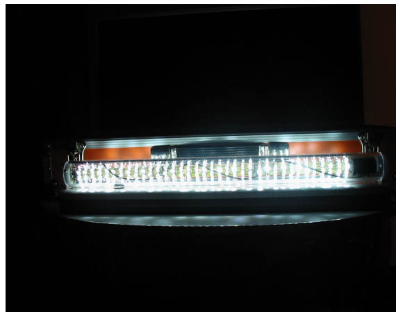
Figur 5-10: Den færdige prototype inde i plexiglasrøret, monteret i et armatur.
