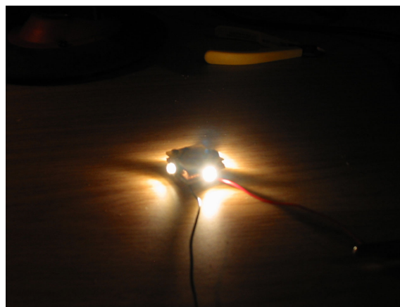
Figur 5-12: Lysudbyttet fra et radialplan. Som det ses dannes der fire "skyggevinkler" imellem lysdioderne.
