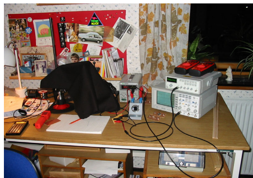
Figur 4-8: Den samlede testopstilling til PWM-test af lysdioderne. Til venstre "mørkekammeret", til højre det elektriske udstyr.
