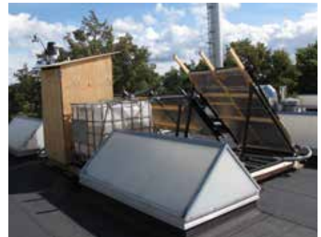
Eksperimentets opbygning med tre serieforbundne PV/T paneler og en uglaseret solfanger.
