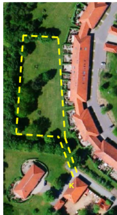
Foto 1: Område med jordvarmeslanger er markeret med gult, kedelcentralen med K.
