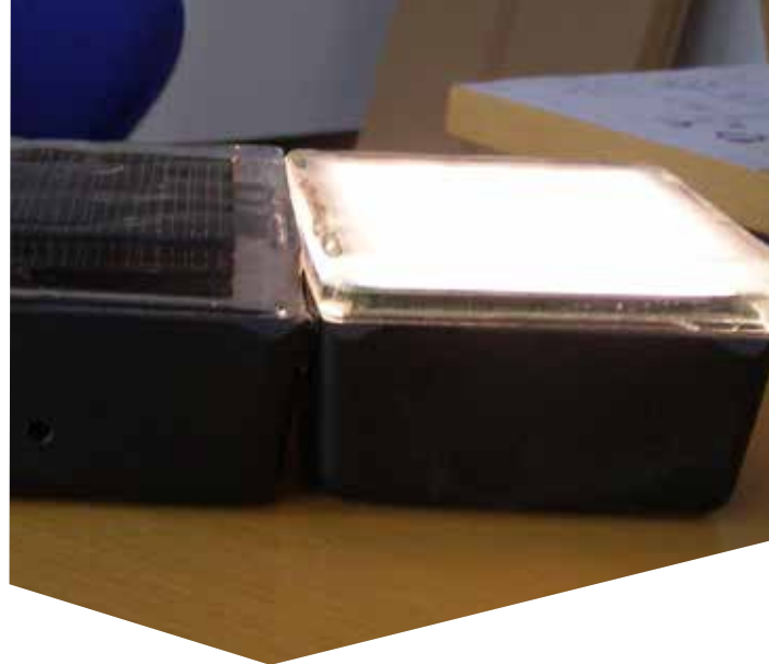
Billederne viser prototyperne, fra venstre soldrevet OLED pullert, OLED belysning i dobbeltsten og skilt med OLED og solceller.
