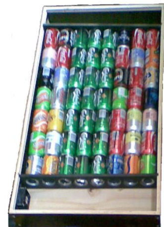
Varmluftsolfangeren før coladåse-rørene blev malet
