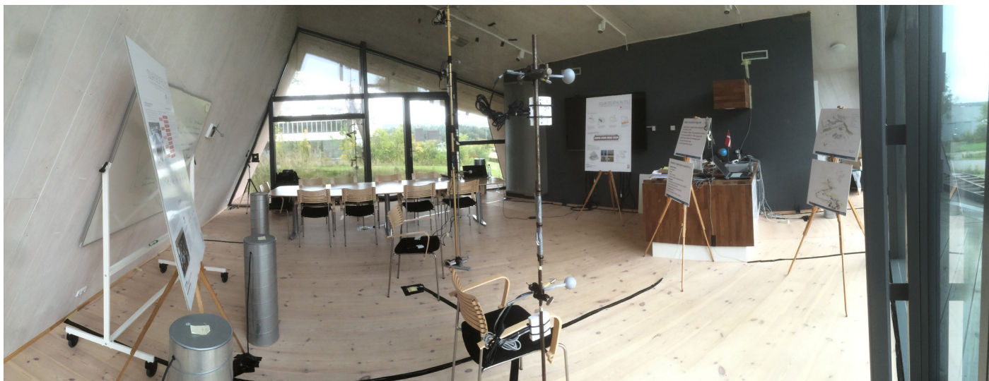
Under projektføreløbet indsamlede de studerende data om husets energiforbrug, el-produktion fra solceller, inde- og udetemperaturer og udførte eksperimenter med opvarmning, køling og ventilation.
