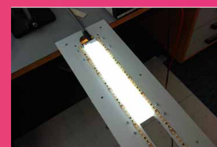
Foto af fiberlys koblet ud af lysblandingsklodsen. Hvide LED'er i hybridarmaturet er ikke tændt.
