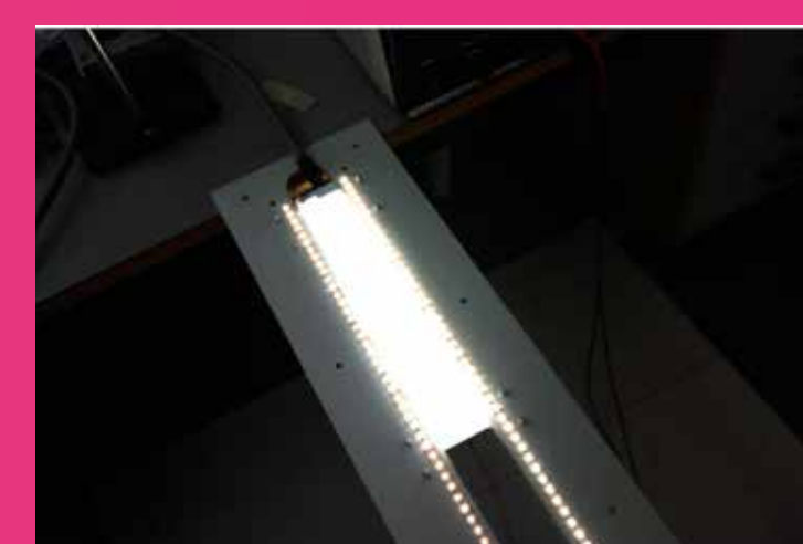
Foto af fiberlys koblet ud af lysblandingsklodsen, hvor de hvide LED'er i hybridarmaturet er tændt.
