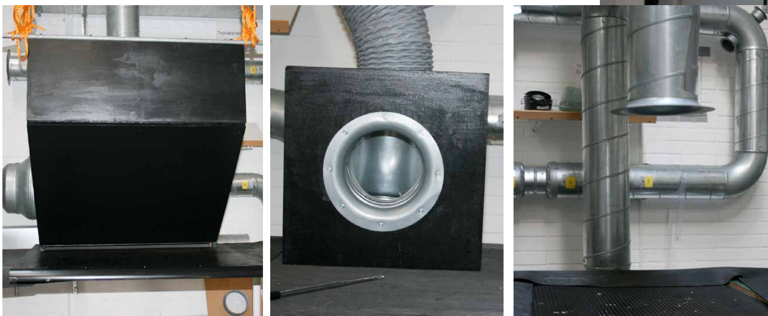
Eksempler på 3 forskellige udsugningsløsninger. Fra venstre udsugningseffektivitet: 1,0 - 0,5 - 0,25
