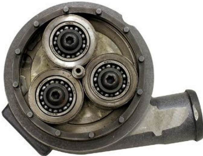
Figur 6. Turbokompressor sammenbygget med et højhastigheds friktionsgear (Rotrex).
