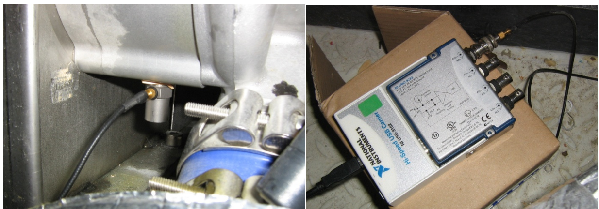
Figur 48. Accelerometer fastlimet til varmeisulator under gearhus (tv) og signaltransmitter (th).
