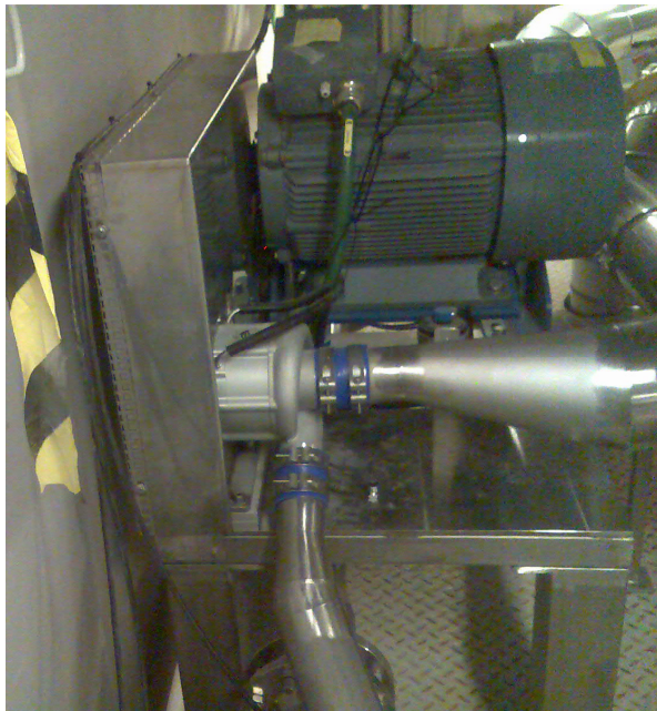
Figur 35. Nærbillede af Rotrex turbo-kompressor med blå siliconeslanger på ind- og udløb, og til højre Danfoss 55 kW frekvensdrev.
