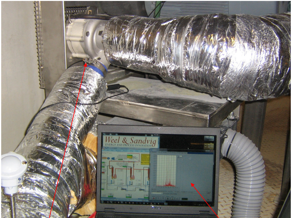
Figur 49. Accelerometer på undersiden af gearhus til måling af vibrationer med software fra Colding A/S.
