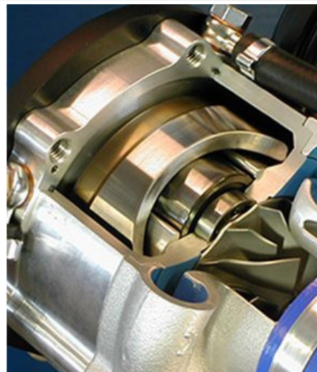
Figur 6. Turbokompressor sammenbygget med et højhastigheds friktionsgear (Rotrex).
