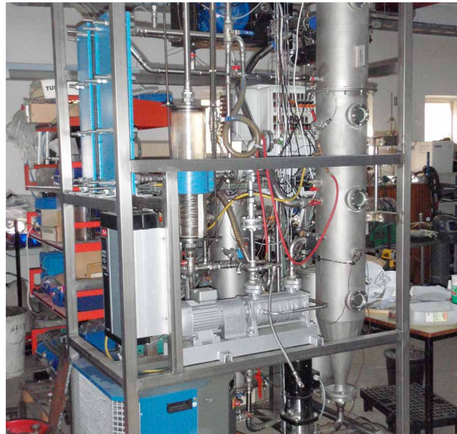
Et forsøgsanlæg med en varmepumpe baseret på vanddampkompression på Teknologisk Institut gik forud for den egentlige demonstrationsdrift hos Haldor Topsøe A/S.
