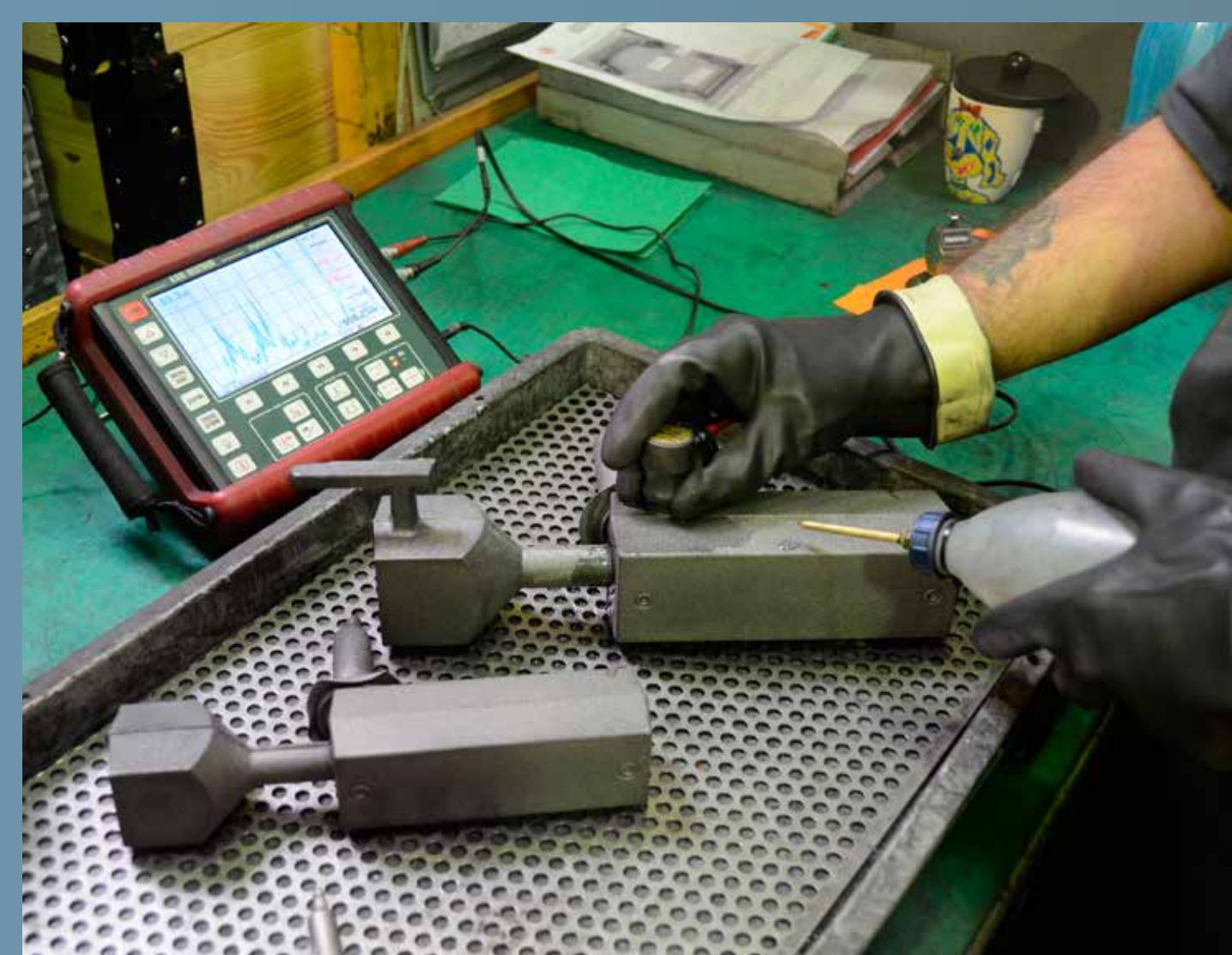
Ultralydsanalyse af støbegods. Apparatet udsender ultralyd, som reflekteres på bagsiden af støbegodset og derefter registreres af apparatet. Ultralyd kan bruges til at finde defekter og porøsiteter i godset, men kan også påvise, om godset er gråt- eller sejjern.
