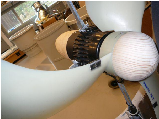
Fig. 8.3.1.4-1 Diffusoren og indløbskugleskallen
