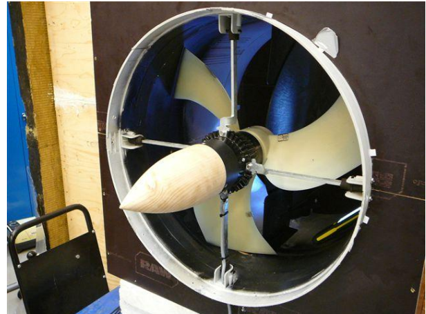
Fig. 8.3.1.4-2 Diffusoren og indløbskugleskallen
