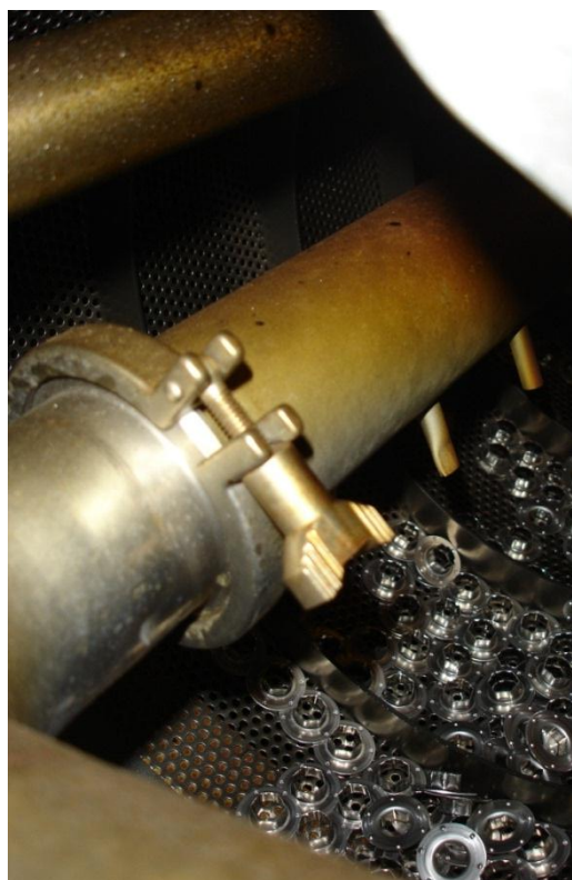
Figur 3.4: Tørresektion i tromlevasker.
