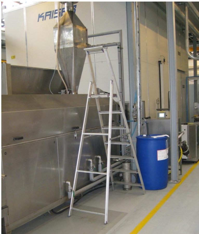
Figur 5.6: Vaskemaskine med indbygget varmeveksler.
