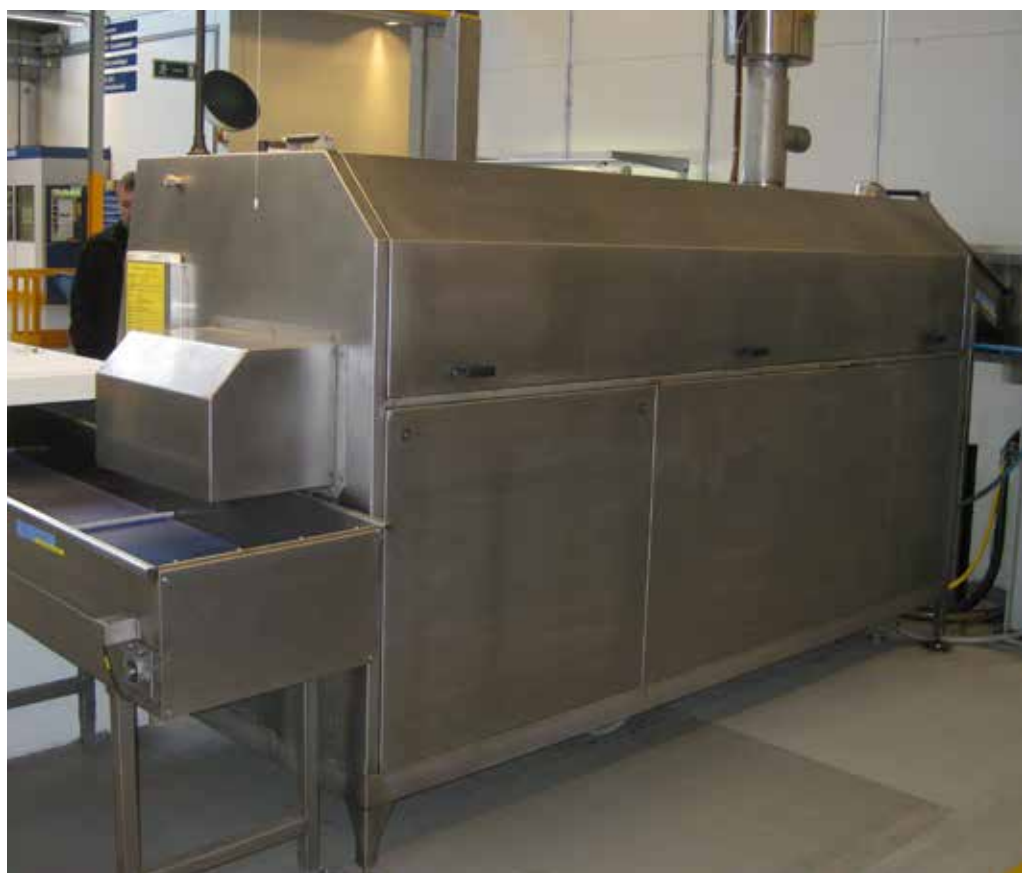
Gennemløbsvasker (tromle) hos Grundfos, der var vært for projektets demonstrationsanlæg
