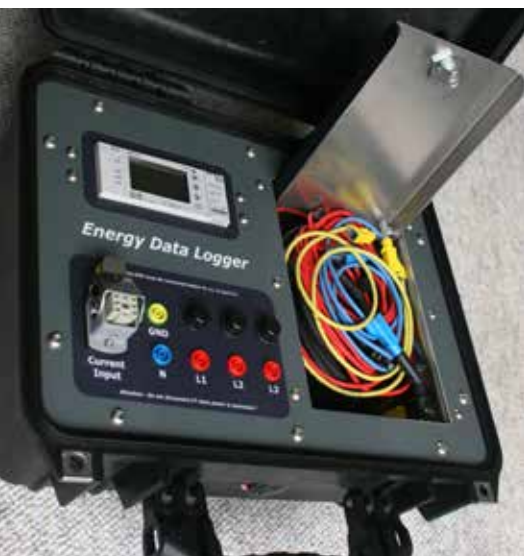
KSN har udviklet en "energikuffert", der gør det let at foretage de nødvendige målinger på konkrete vaskeanlæg.
