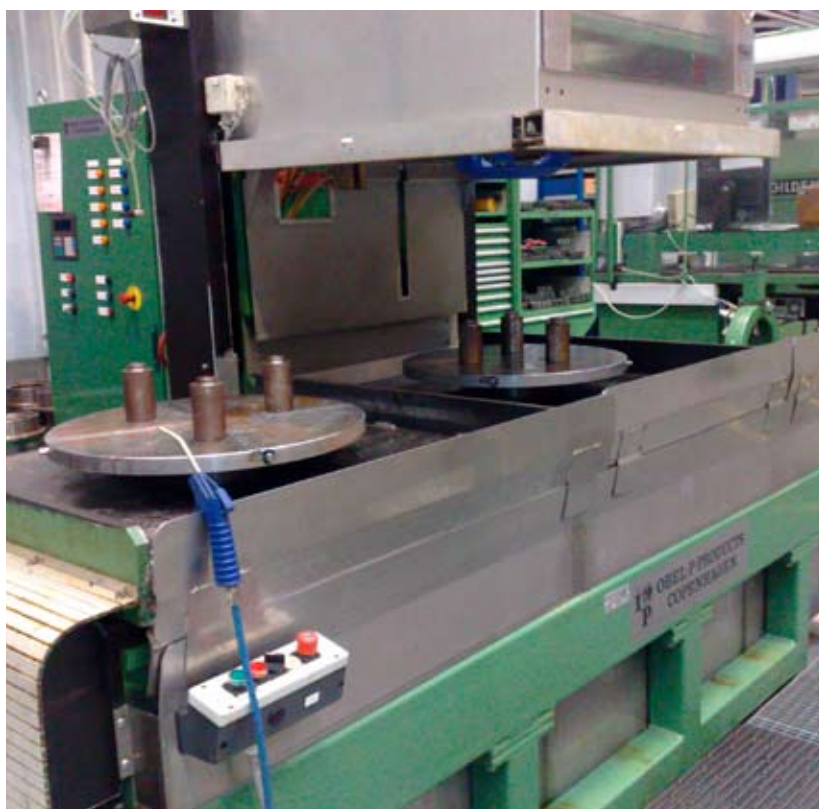
MAN Diesel A/S sparede over 85 procent på energiforbruget til behandling af bundstykker ved at anskaffe en ekstra induktionshælder til håndtering af anløbning. Foto: Teknologisk Institut
