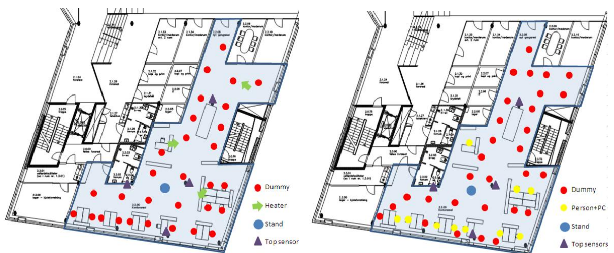
Figur 12 Scenarie 1 med dummies og varmeblæsere (billede til venstre). Scenarie 3 med dummies og personer (billede til højre)
