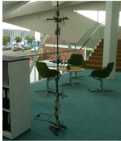
Figur 16 Målestation til spotmålinger på 1. sal, kontorplateau 2.1.23.
