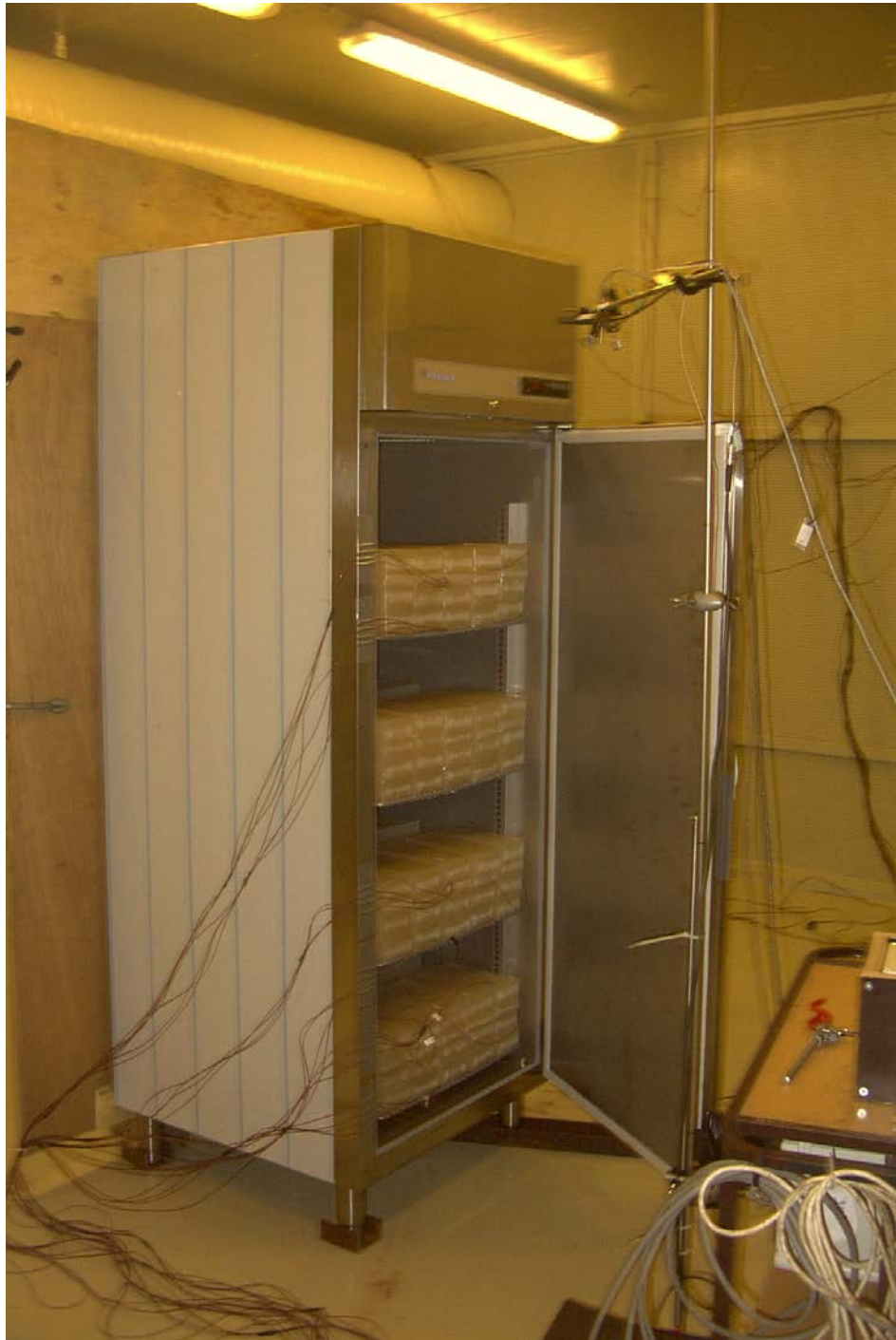
Foto af skabet i klimakammer på Teknologisk Instituts kølelaboratorium i Aarhus. Fotoet er taget under en døråbning, og man ser lasten af prøvepakker på de fire hylder. Man ser ligeledes ledninger til testpakker gå ind i skabet.
