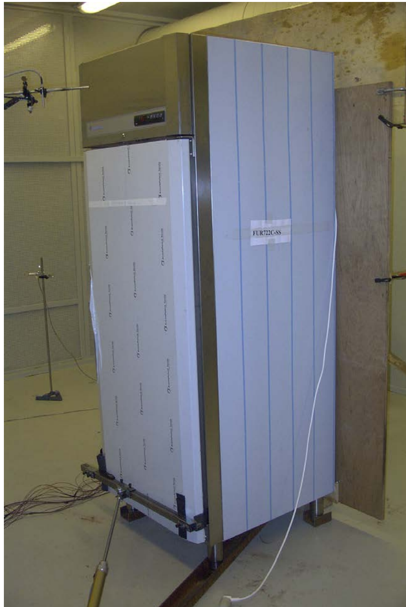
Foto af Porkka Future C722-SS med lukket dør. Man ser den blå beskyttelsesfilm ovenpå stålpladerne. Forneden på døren er monteret skinne og pneumatisk cylinder til døråbningsrobot.
