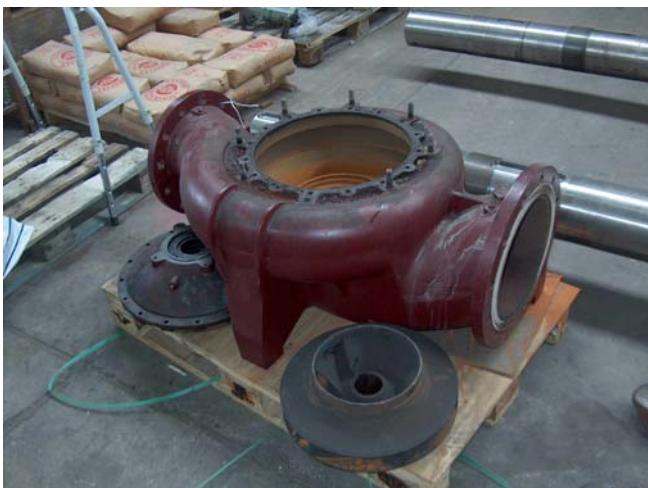
Billede 5: Pumpe og løbehjul ankommer på palle til serviceværksted for coating.
