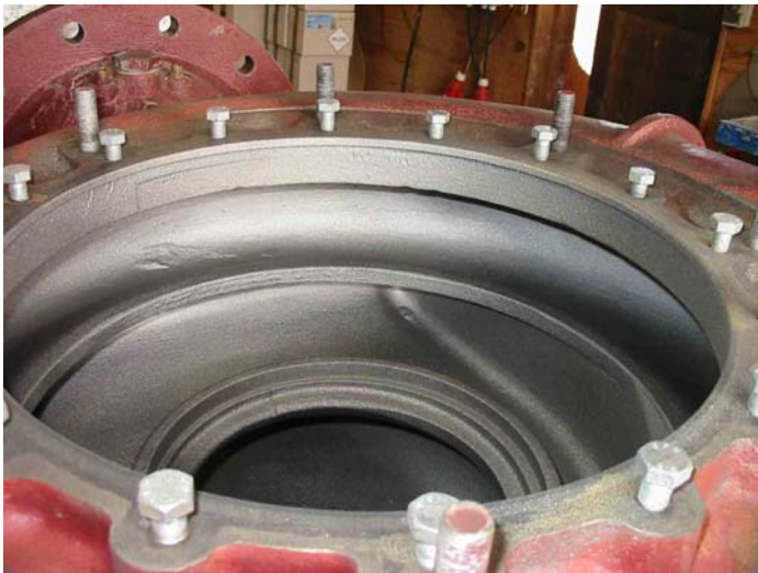
Billede 6: Sandblæst pumpehus til renhedsgrad Sa2½ til Sa3.
