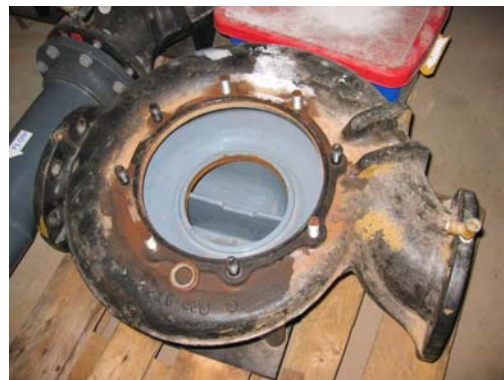
Billede 10: Løber og pumpehus coatet med ARC S2 efter 8 måneders drift i klorvand.
