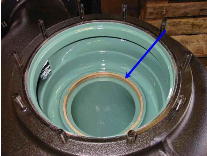
Billede 9: Coated pumpe med ucoatet slidring (blå pil). Kilde: Jakob Albertsen A/S
