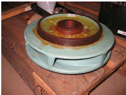
Billede 10: Løber og pumpehus coatet med ARC S2 efter 8 måneders drift i klorvand.
