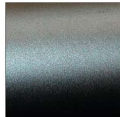
Sandblæst stål overfalde til renhed Sa 2,5 - 3. Alle urenheder er fjernet og overfladen er fri for skygger. Overfladeruhedsprofil (R-max) skal være 75 til 125 my.
