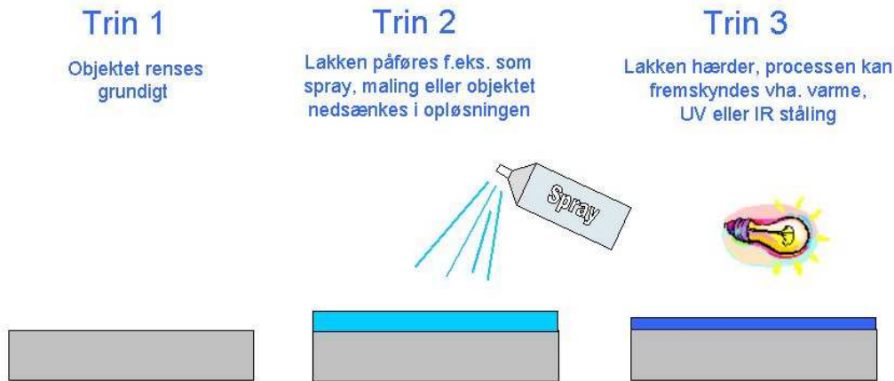
Figur 17: Skematisk oversigt over Sol-gel-teknologien. Sol-gel-teknologien bygger på nanoteknologien, hvor de korrosionsbeskyttende eller hærdende materialer findes i lakken som nanopartikler, der danner et netværk på overfladen ved hærningen,
