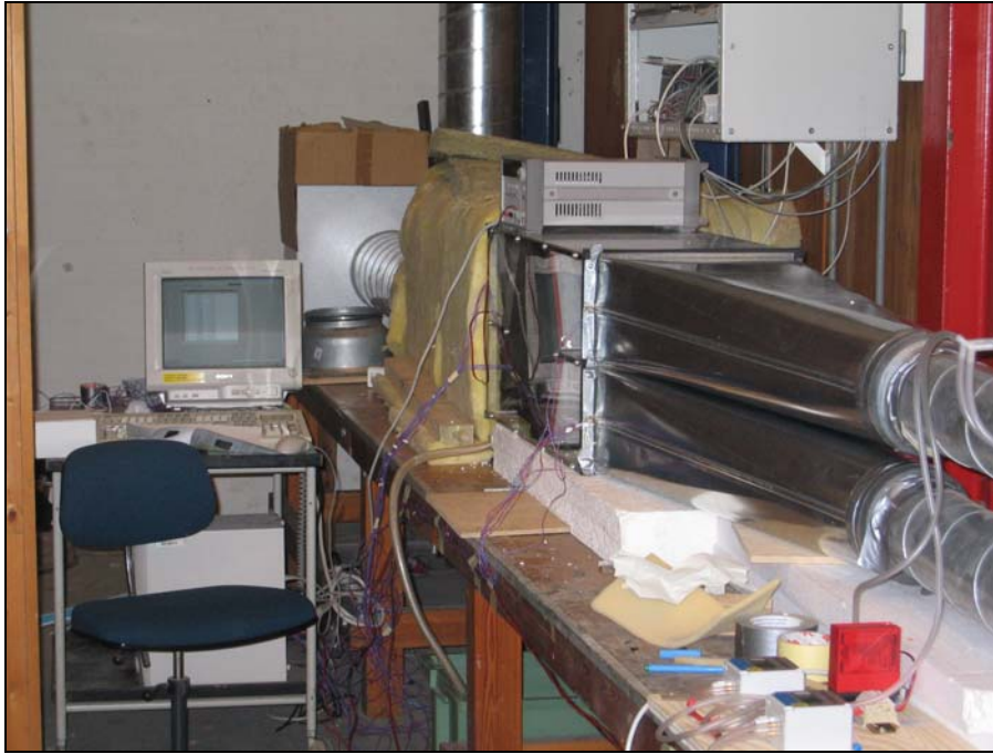
Figur 6-1 Forsøgsopstilling ved Danmarks Tekniske Universitet til undersøgelse af kondens og isdannelse..
