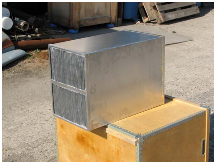
Figur 3-4 viser den færdige prototype veksler.
