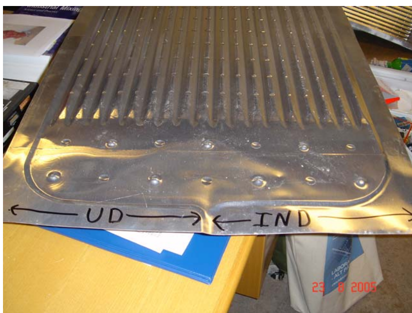
Figur 4-4 viser et eksempel på tidligere model af modstrømsveksler i aluminium. Bredden af et ind- og udløb er markeret på den samme plade selvom luften i praksis selvfølgelig ikke bliver blandet i samme lag.
