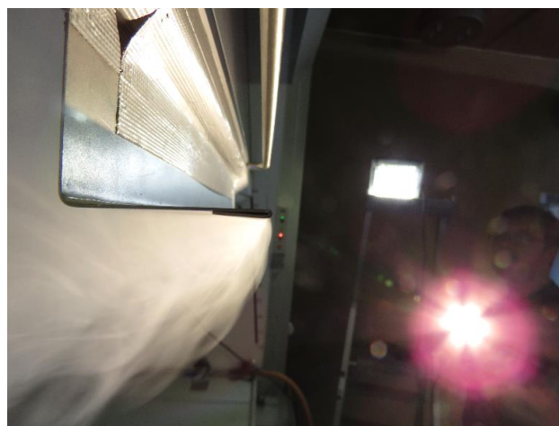
Figur 9.5 - Til venstre ses en løsning af en skrånstillet lugeunderkant og til højre en 90 grader bøjning pegende ud af stinkskeb.
