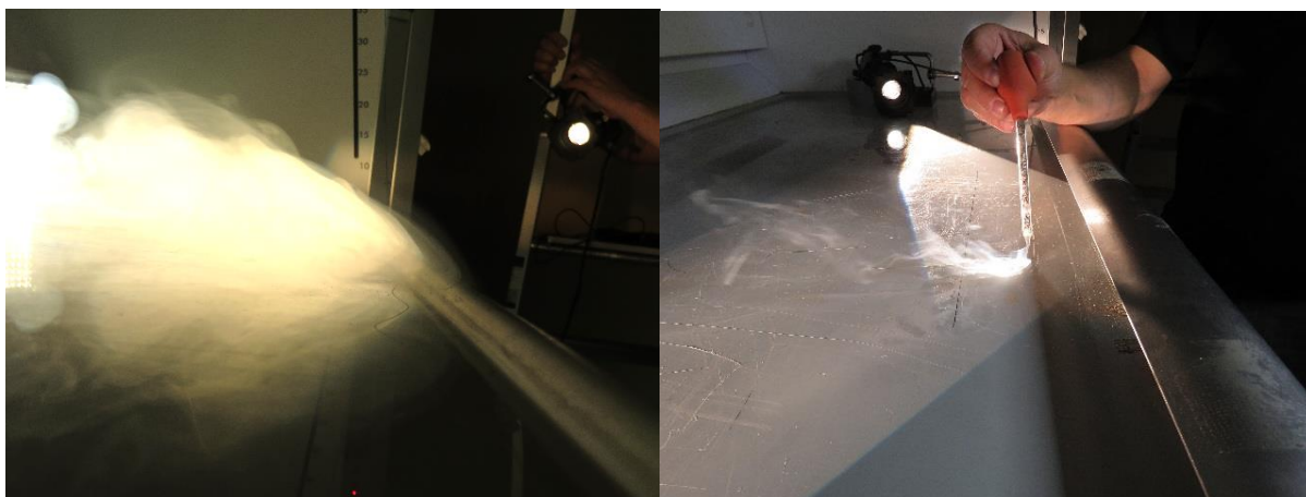
Figur 9.1 - Til venstre ses en løsning af en bordforkant uden en airfoil og til højre en bordforkant med en airfoil.
