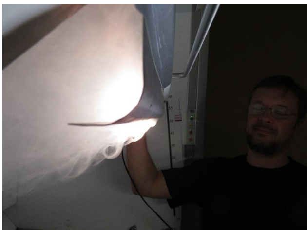
Figur 9.6 - På billedet ses en løsning af en lugeunderkant som er halvafrundet pegende indad i stinkskalet.
