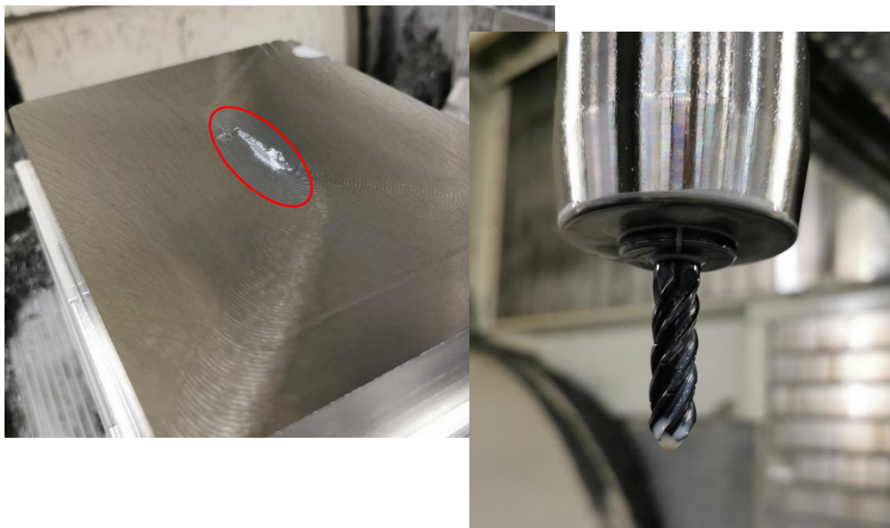
Figur 11: Værktøjsbrud under indkøring i stål
