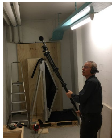
Figur 30. Foto af forsøgsopstilling i væg mellem to kælderrum hos Sweco.
