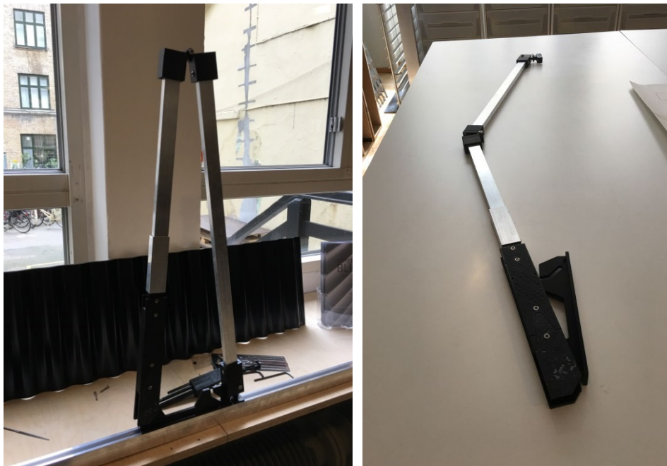
Figur 10. Den endelige version af lukkebeslaget, til venstre monteret på styreskinnen i position svarende til at skodden er i åben position, til højre beslaget i position svarende til næsten lukket skodde.
