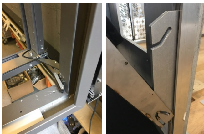
Figur 8. Lukke- og låsebeslag, funktionstest af prototype i laboratoriet.
