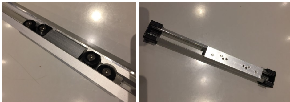
Figur 13. Den nye variant af styreskinne som er lidt kraftigere end standardskinne, og som ved hjælp af små gummihjul sikrer en præcis bevægelse af vognene, der drives af den roterende spiral.
