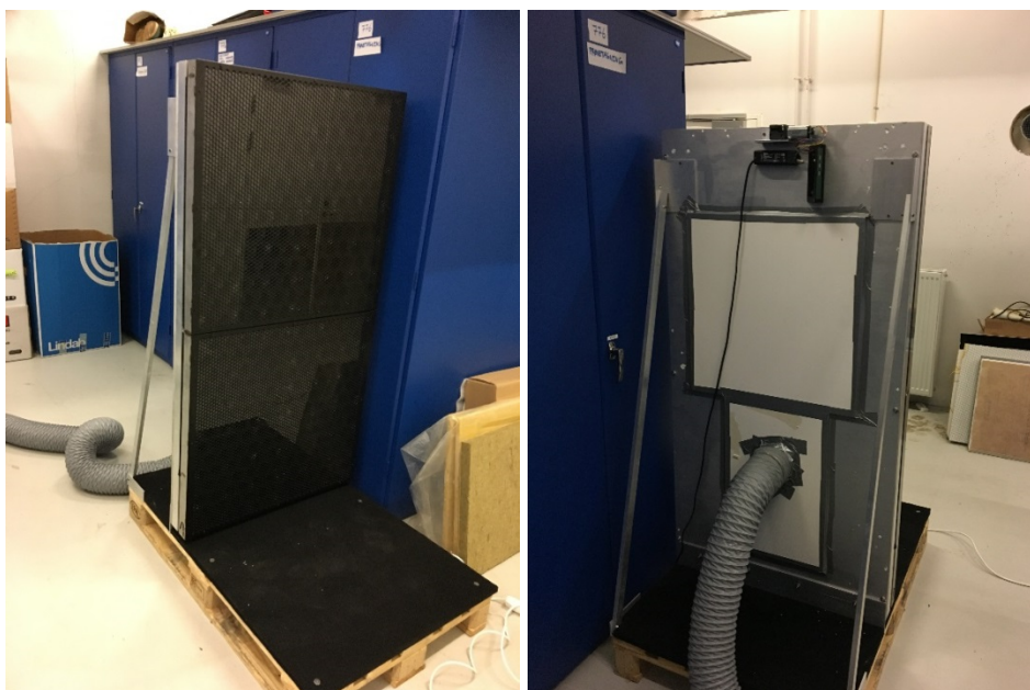
Figur 26. Forsøgsopstilling af foldeskodden ved trykprøvningsforsøgene.
