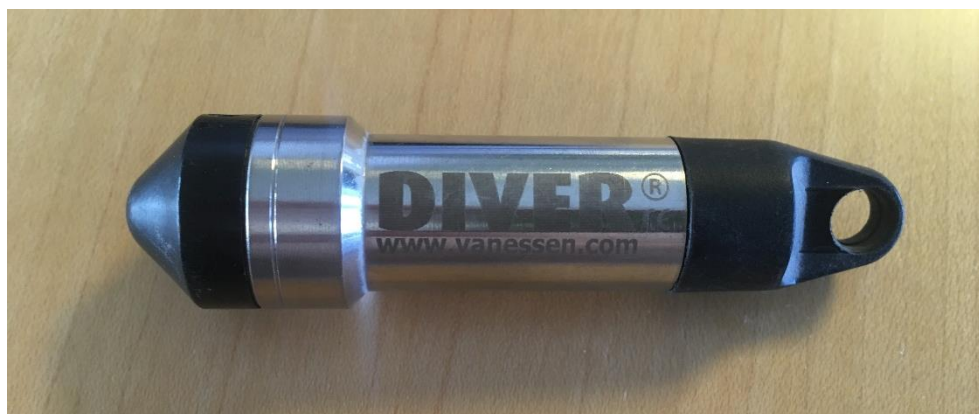
Figur 3: Datalogger til temperaturmålinger af spildevand
