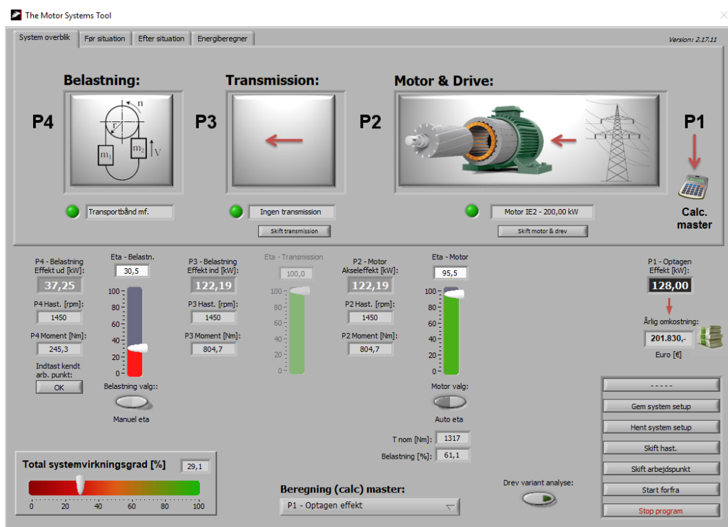
Figur 8.35. Systemvirkningsgrad for kølekompresor ved 50 % af nominel køleydelse
