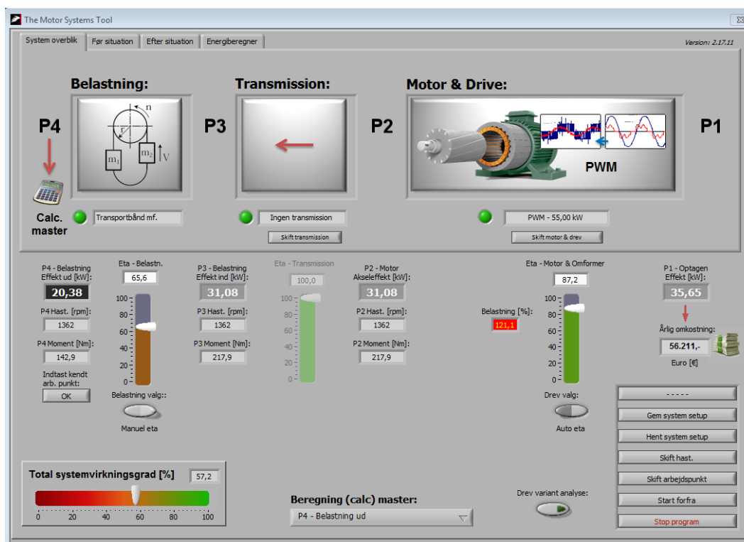
Figur 8.26. Systemets totalvirkningsgrad efter reduktion af flowet
