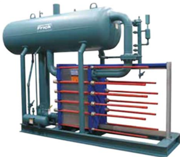
Figur 2. Oversvømmet fordamper med separator (placeret øverst). Faldrøret er placeret mellem underside af separator og fordamper. Returrøret er placeret mellem top af separator og fordamper.
