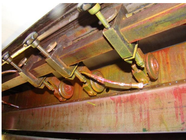
Figur 4.23 Trykluft til fremføring af farve til rotationsmaskiner
