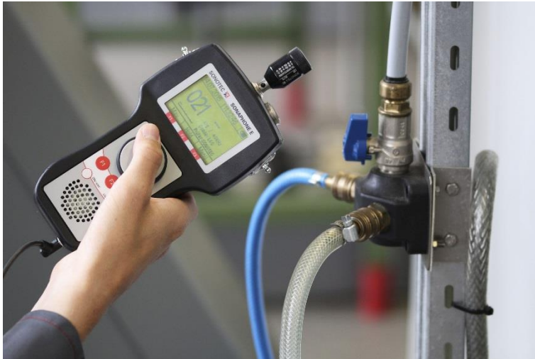
Figur 5.43. Ultralydmåler til lækagesporing
