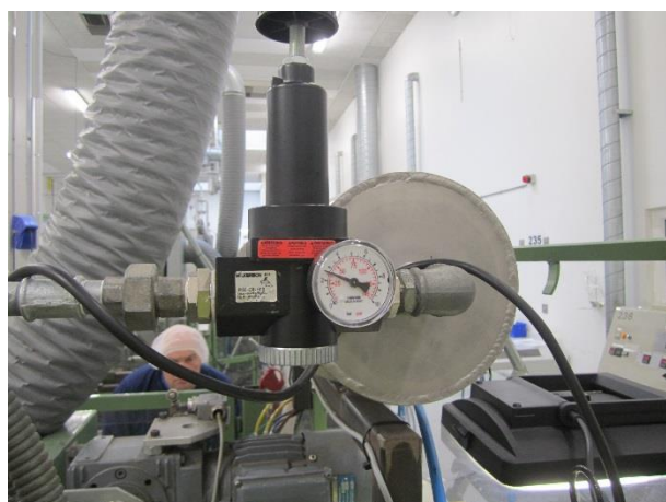
Figur 6.20. Trykreduktionsventil på procesmaskine
