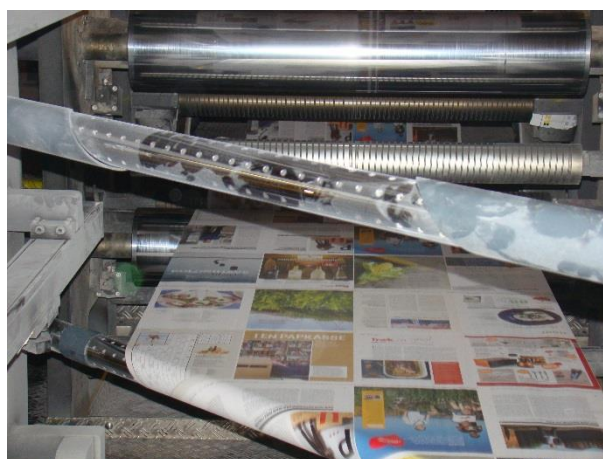
Figur 4.24 Trykluft til rotationsmaskiner
