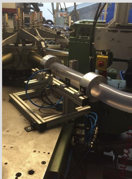
Figur 5.16 Trykluft til fremføring af plastkopper/-svøb.
