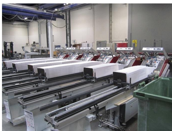
Figur 4.26 Trykluft til adskillelse af tryksager i forbindelse med produktionen/pakning
