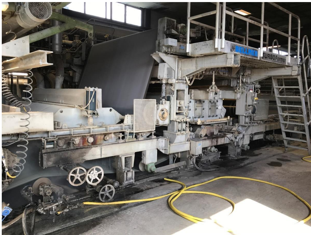
Figur 6.5 Papirmaskine der forsynes med vakuum fra vandringspumper
