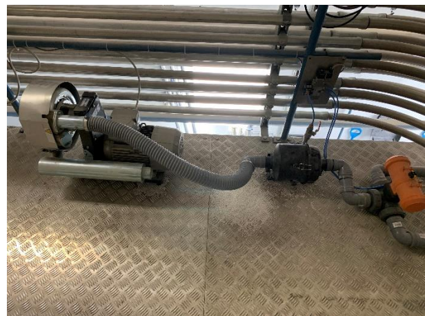
Figur 3.4 Vakuumsystemer til materialetransport (plastgranulat)
