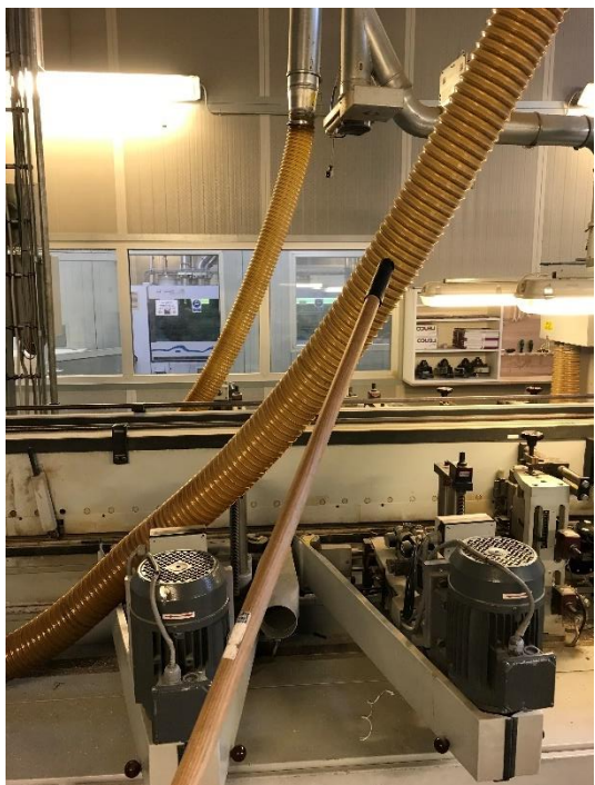
Figur 10.2.7 Flexslangehastighed lig 35 m/s og P_{\text{statisk}} lig -3200 Pa (tv). Flexslangehastighed lig 21,4 m/s og P_{\text{statisk}} lig -3400 Pa (th).
