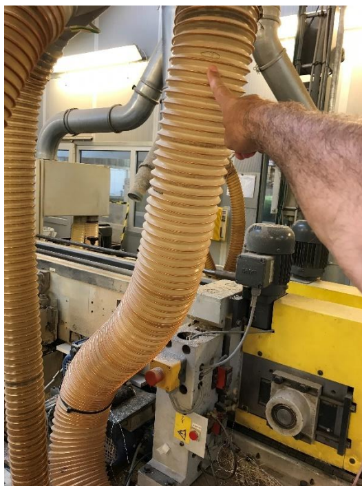
Figur 10.2.7 Flexslangehastighed lig 35 m/s og P_{\text{statisk}} lig -3200 Pa (tv). Flexslangehastighed lig 21,4 m/s og P_{\text{statisk}} lig -3400 Pa (th).
