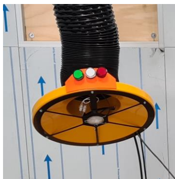
Figur 8.2.21 Indikationslamper monteret på Geovent sugearm.
