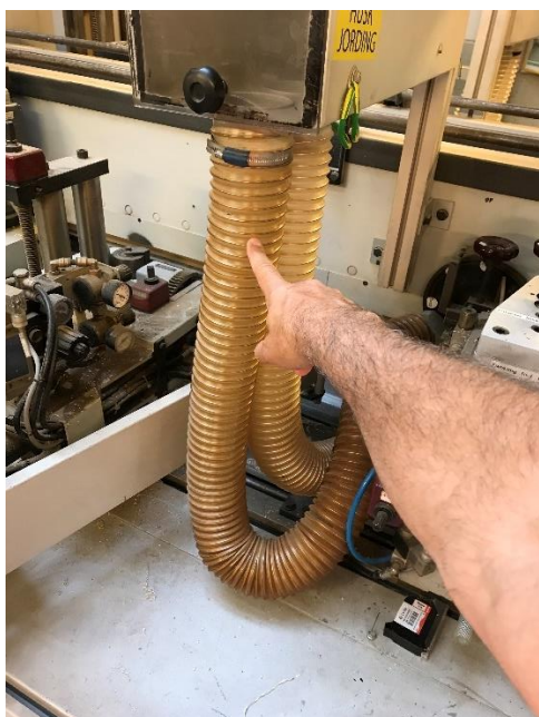
Figur 10.2.8 Flexslangehastighed lig 18 m/s og P_{\text{statisk}} lig -3400 Pa (tv). Flexslangehastighed lig 13 m/s og P_{\text{statisk}} lig < -3400 Pa (th).
