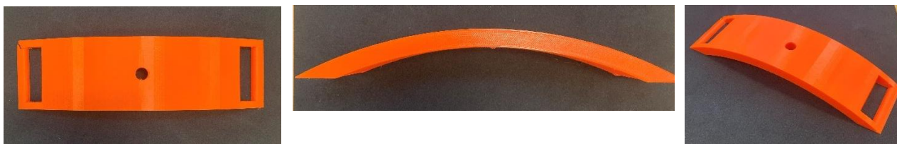
Figur 9.2.8 Færdig 3D-print af monteringspladen.
