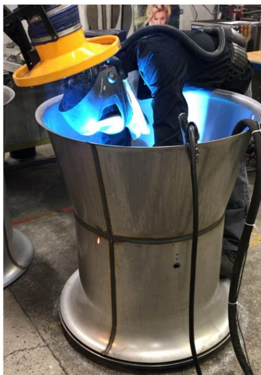
Figur 8.3.5 På billedet ses systemet i aktivt brug. En Novenco medarbejder iført åndeværn er i gang med at svejse på et blæserhus.
