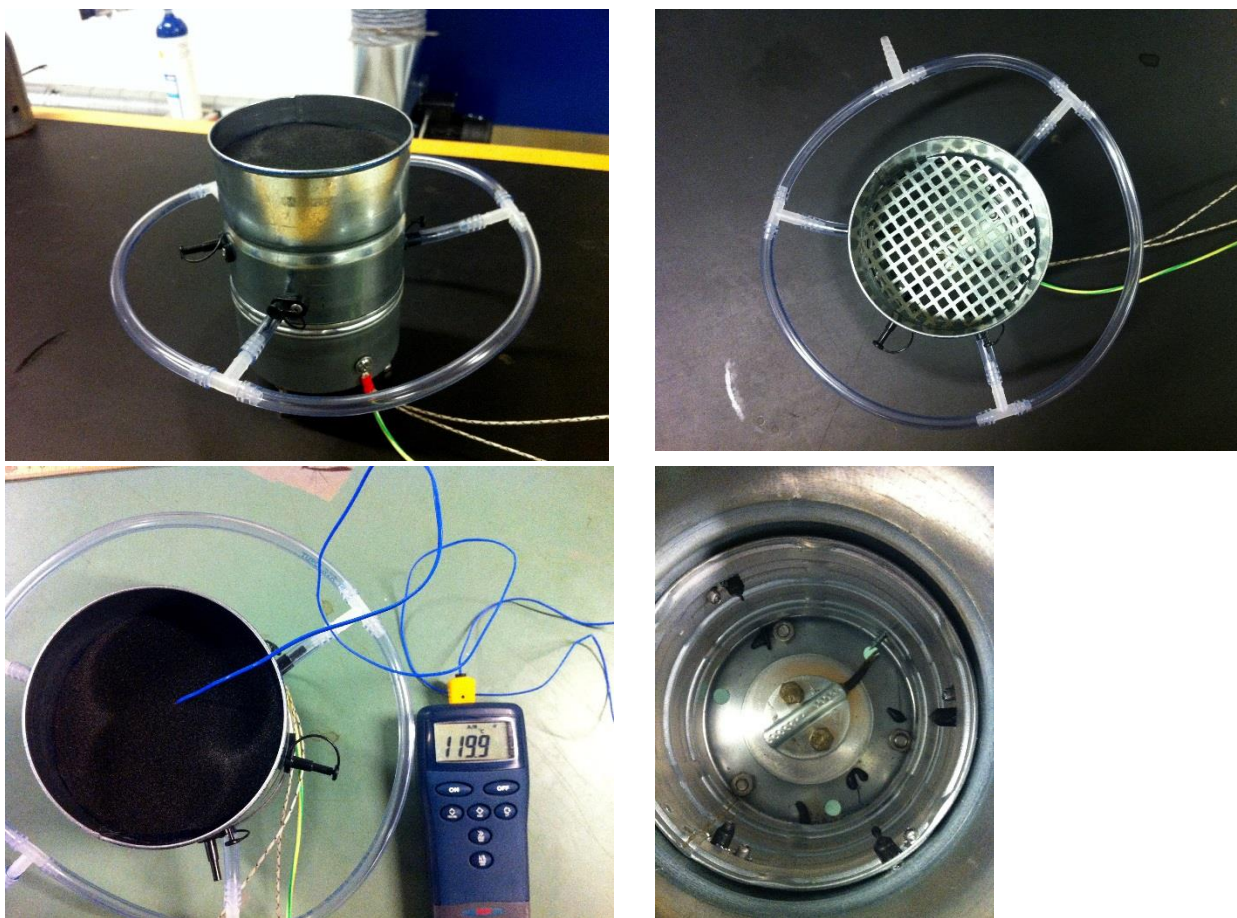
Figur 7.2.2 Billedserien viser sporgaskildens opbygning. Overfladetemperaturen kan gå helt op til omkring 1.200 °C.
