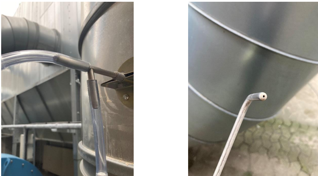
Figur 9.3.15 Undersøgelse af pitotrør ved nedtagelse.
