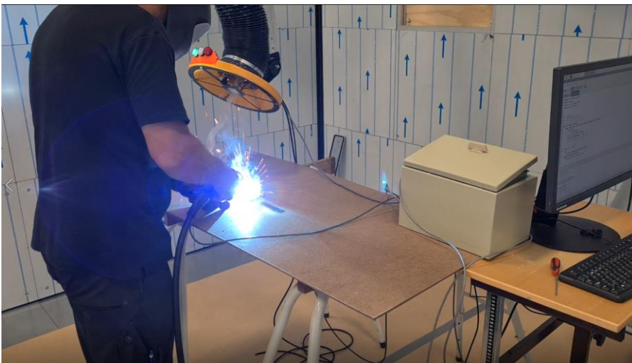
Figur 8.3.3 Svejseforsøg i Indeklimalab.
