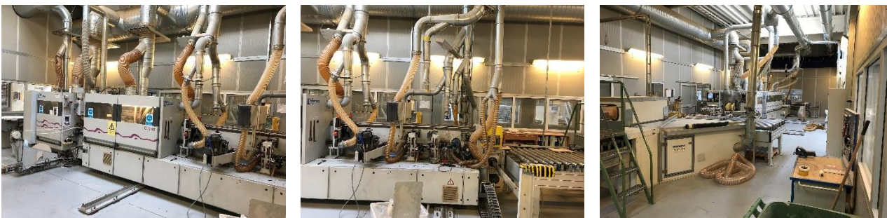
Figur 10.2.6 Billeder af proceslinjen med procesudsug og recirkulationsindblæsning.
