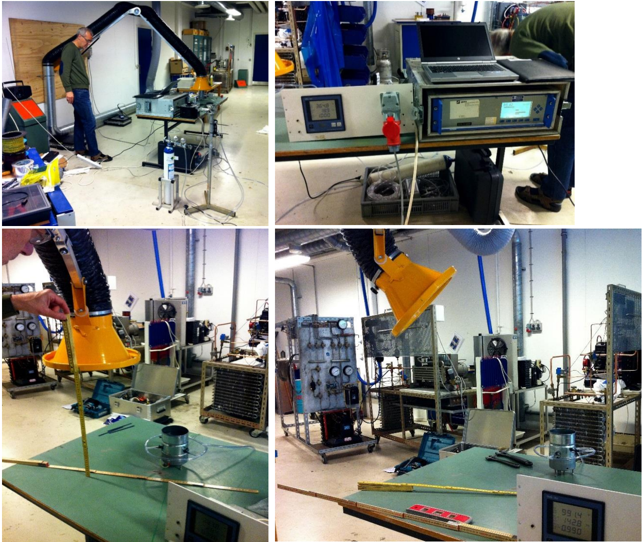
Figur 7.2.1 Billedserien viser opstillingen i laboratoriet til måling af udsugningseffektivitet under forskellige forhold.
