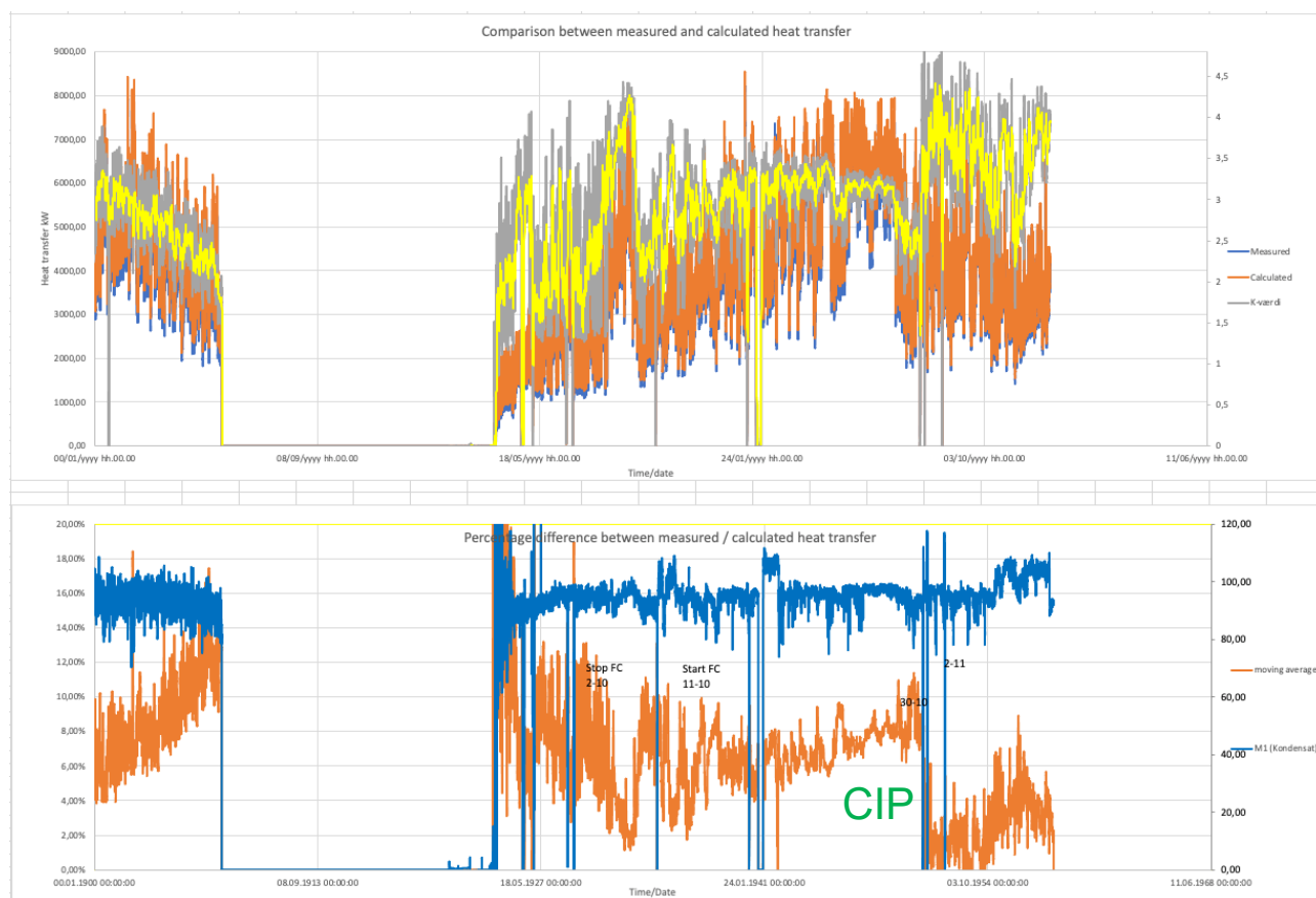
Figur 5: Udvikling i K-værdi, den gule linje (varmeledningsevnen for denne veksler) fra februar 2020 til april 2021 på pladevarmeveksler med FoulingCure.
