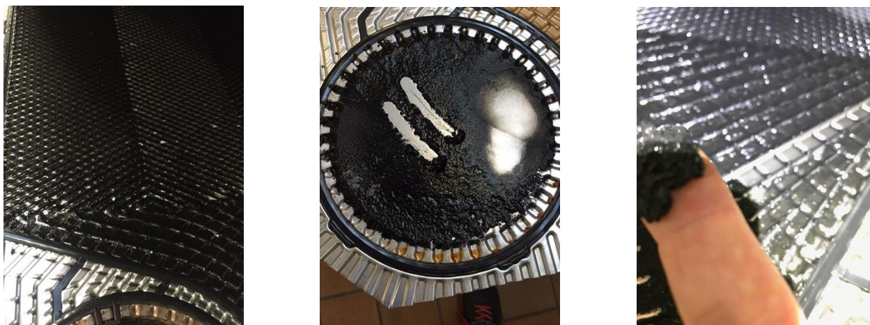
Figur 1: Kraftig Fouling på Pladevarmevekslerplader hos VERDO sæson 2018-2019..
