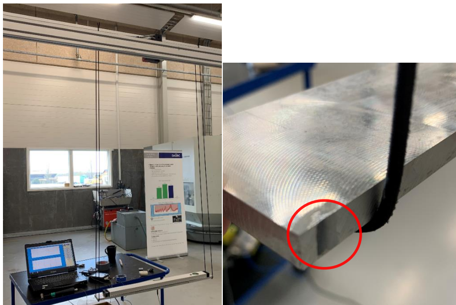
Figur 30: Eksperimentel opstilling af modal analyse med elastiksnor og markering af elastiksnor placering.
