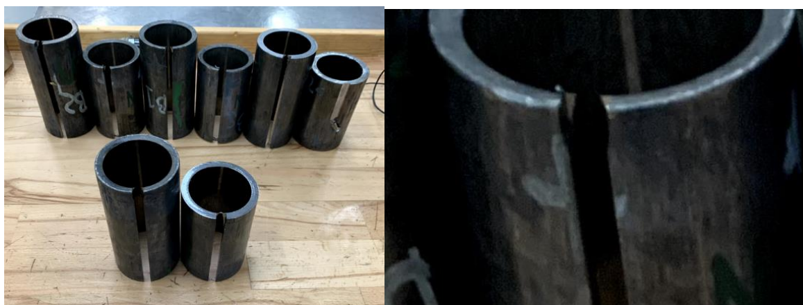
Figur 51: Fræsede hule rør.
