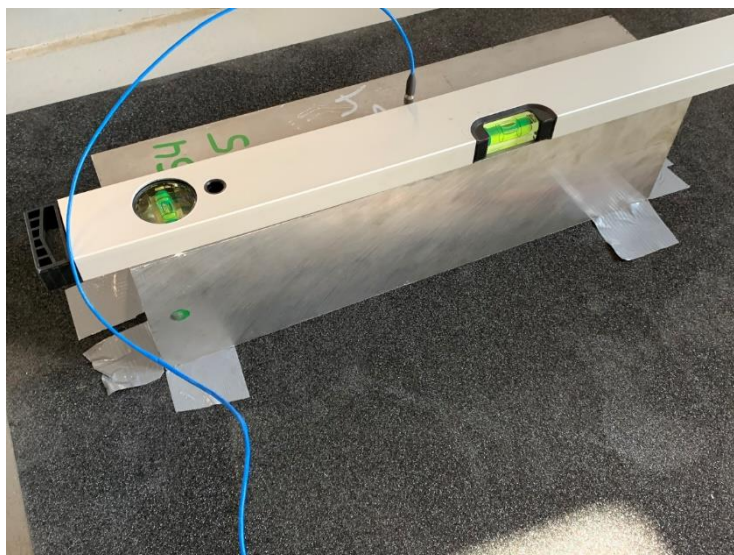
Figur 29: Forsøgsopstillingen med bjælken, accelerometeret, skumunderlaget og vaterpasset.
