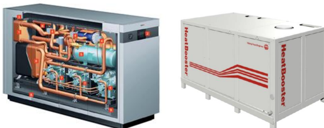
Figur 6.23 Et eksempel på en R1234ze(E)-varmepumpe fra Viessmann (Viessmann-brochure) til venstre. Til højre et anlæg fra Viking, der anvender 1336mzz(Z) og kan nå 150 °C.
