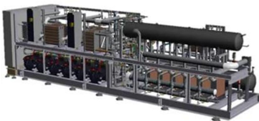
Figur 6.8 Typisk konfiguration af CO 2 -varmepumpe med rack af kompressorer – her en Carrier Refrigeration PowerCO2OL (Carrier).
