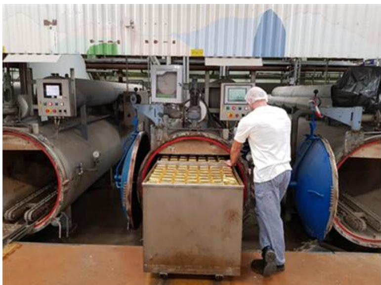
Figur 9.1 En autoklave fyldes med bægere med katte-/hundefoder.
