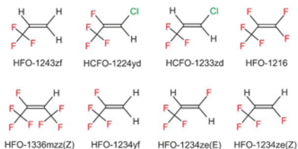
Figur 5.15 Kemisk opbygning af forskellige HFO-kølemedler.
