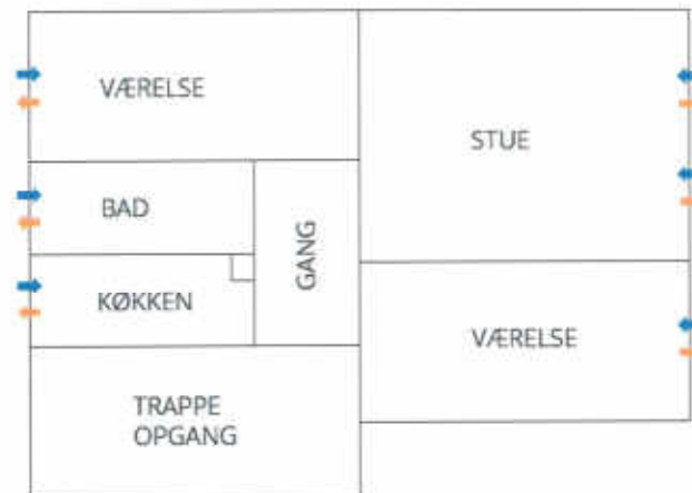
Princip for grundluftskifte
