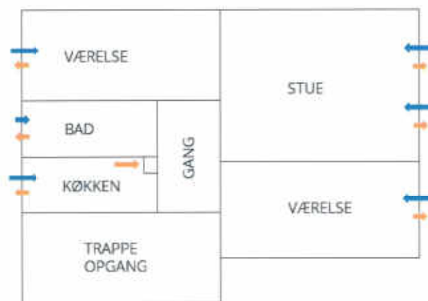
Princip for forceret udsugning fra emhætte
