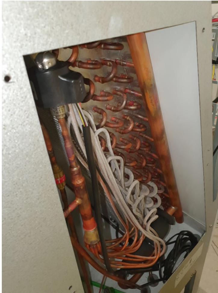
Foto: Første udgave af prototype 2. Der er tydeligvis en skævfordeling af kølemiddel i fordamperen. Det kan man se på den asymmetriske tilrimning af fordamperrør og fordelingsrør.
