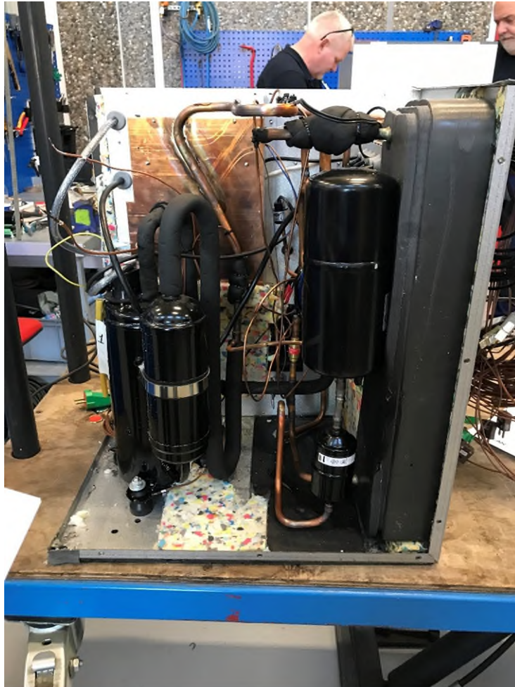
Foto af opbygning af prototype 2 i prototypeværkstedet hos Nilan. Man ser kompressor og sugeakkumulator/olieudskiller bygget sammen fornedet til venstre. Helt til højre er kondensatoren (pladevarmeveksler). Imellem er reciever og nedenunder denne: kølemiddel-filter.
