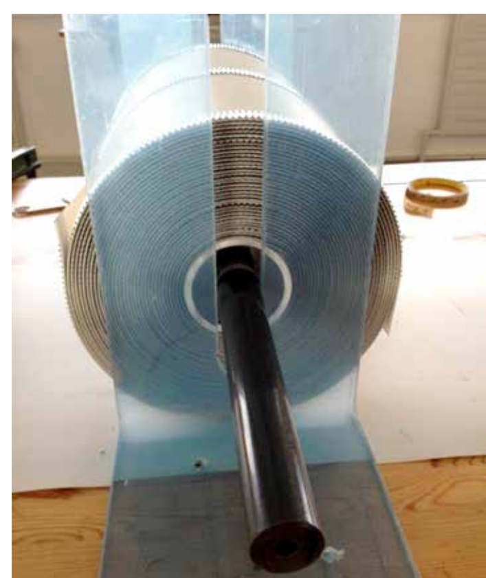
Billede af test-setup på DTU, hvor spiralvarmeveksleren testes for sin varmegenvindingseffektivitet (venstre).
